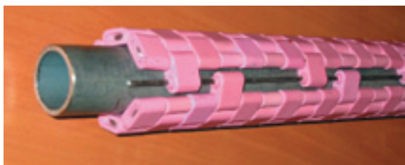
Фото 1. Электрический подогреватель воздуха, используемый при запуске двигателя
