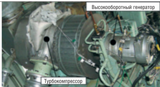
С Фото 4. Внешний вид системы рекуперации энергии тепла отработавших газов
