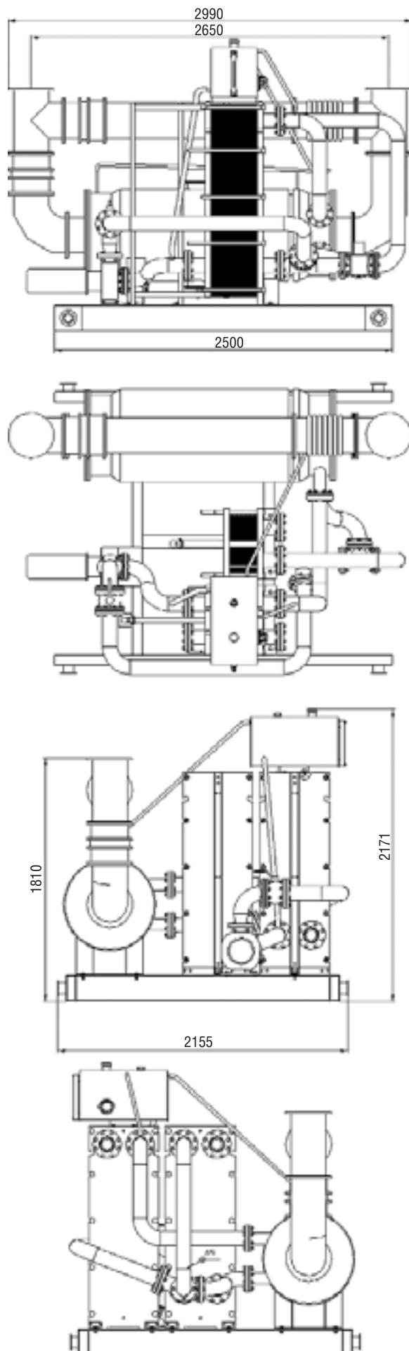
Рис. 2. Общий вид блока утилизации тепла для газового двигателя-генератора мощностью 500 кВт
