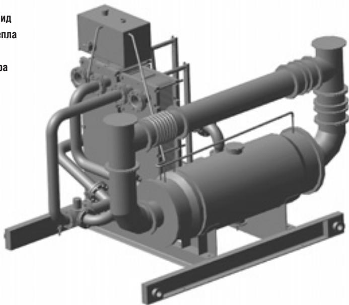
Так, одно из заданий предусматривает изготовление системы утилизации тепла блочного исполнения, общая компоновка которой представлена на рис. 1, а общий вид – на рис. 2.
