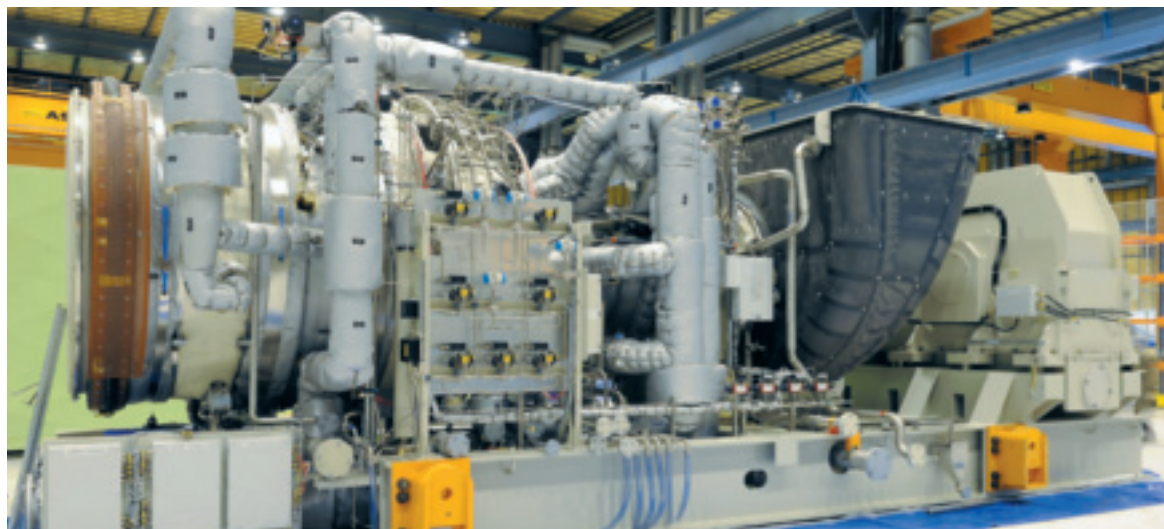
Фото. ГТУ SGT-800 компании Siemens
