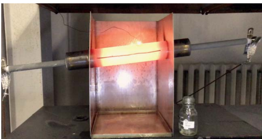
Воспламенение на трубопроводе (коллекторе)
