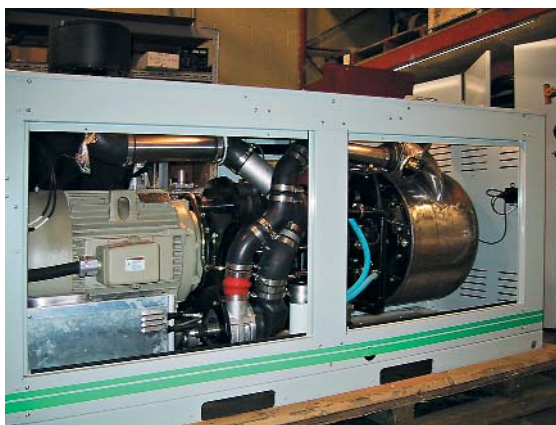
С Фото 1. Энергоблок на базе двигателя Стирлинга
