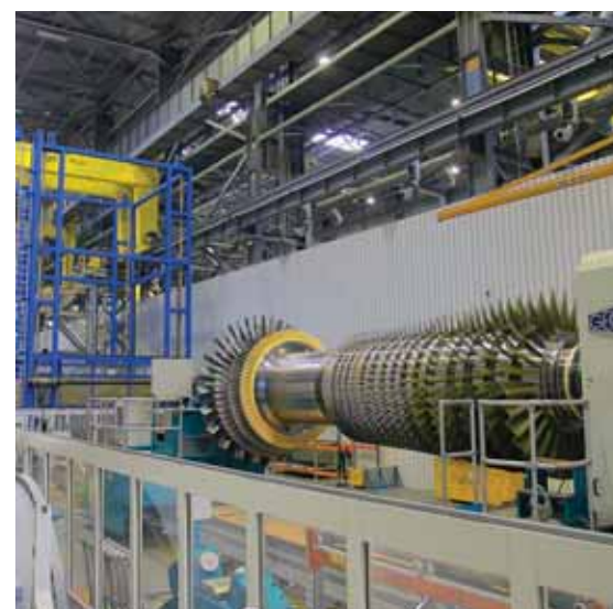
Ротор турбины SGT5-2000E в цехе СТГТ, С.-Петербург
