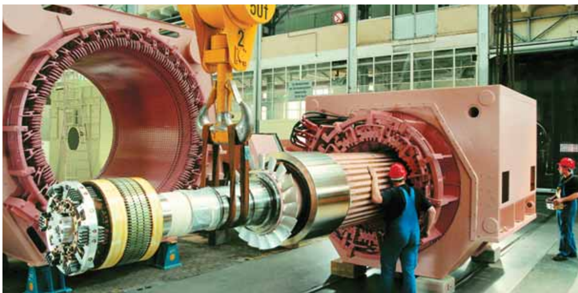
⚙️ Электропривод компрессорного агрегата мощностью 65 МВт для завода СПГ в г. Хаммерфест, Норвегия
