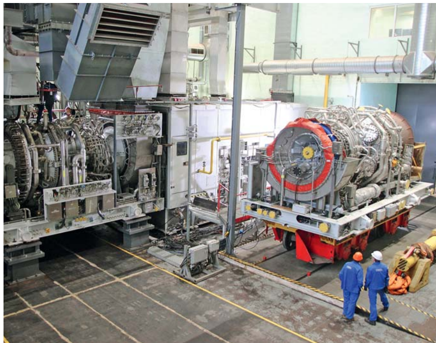
Газотурбинная установка Т32 для ГПА-32 «Ладoga» на испытательном стенде Невского завода
