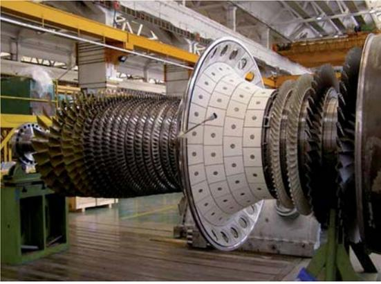
Модификация ГТУ АЕ64.3А Improved выполнена за счет модернизации основных компонентов двигателя. Был использован высокоэффективный компрессор газовой турбины АЕ94.3А, при этом количество ступеней сокращено с 17 до 15 (фото 3, 4). Компрессор обеспечивает массовый расход воздуха на уровне 210 кг/с, степень повышения давления увеличена с 16 до 18, обеспечена более эффективная аэродинамика, на 20 % увеличен запас по помпажу.
