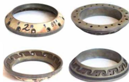
Фото 7. Зона периферийной части горелки, исследуемая методом неразрушающего контроля
