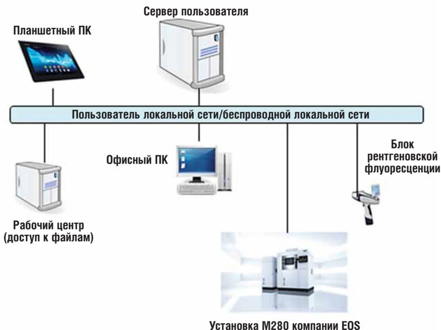
Рис. 5. Архитектура системы MES и ее аппаратная часть, специально адаптированная для процессов ремонта с использованием технологии АН
