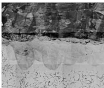
Фото 4. Светооптический микрофото-снимок пограничной зоны наконечника горелки
