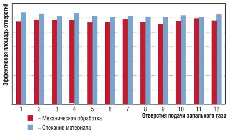
Рис. 9. Сечение потока для отверстий, выполненных механической обработкой и спеканием материала, почти полностью идентично
