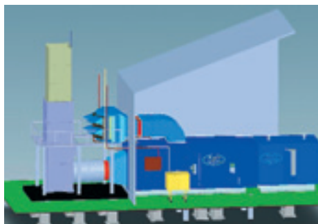
Рис. 2. КМЧ «Корвет-2500»-01 (ЭТ140.01.00.00) в одноконтейнерном исполнении в габаритах ПАЭС-2500 для установки на существующий фундамент
