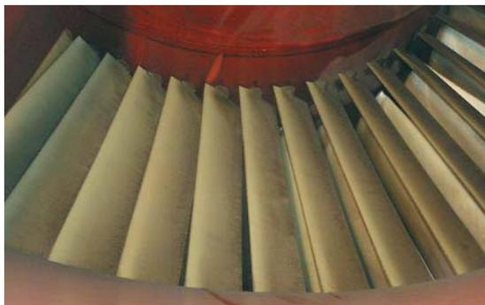
С Фото 1. Загрязнение ВНА и следы начинающегося износа проточной части компрессора после 5000 ч наработки
