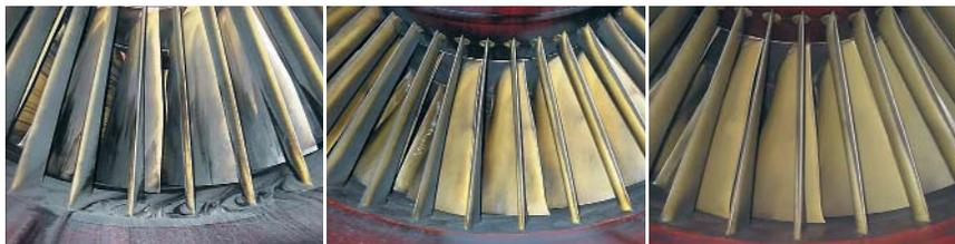
С Фото 2. Степень загрязнения компрессора параллельно работающих ГТУ V84.3A
