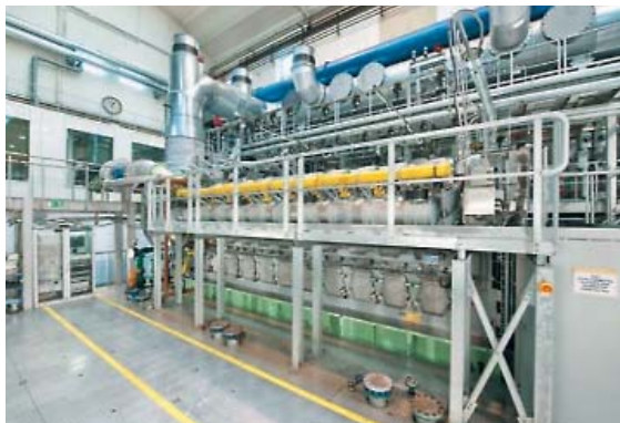
➤ Фото 1. Опытный двигатель 20V35/44G на испытательном стенде в г. Аугсбург, Германия
