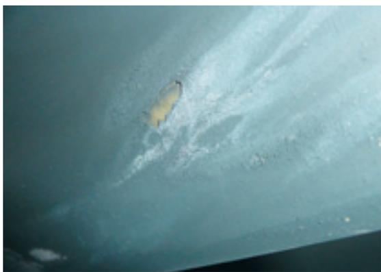
**Фото 3.** Лопатка 4-й ступени компрессора ГТУ V94.2 с системой фильтрации G4-F8
