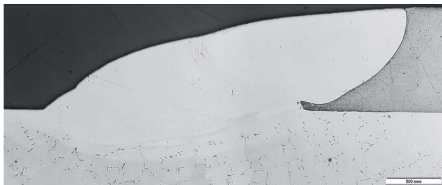
📷 Фото 3. Сварной шов, выполненный ручной дуговой сваркой неплавящимся электродом в среде защитных газов
