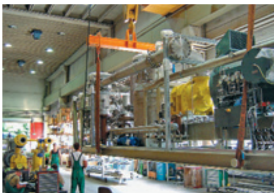
Фото 1. Система газоподготовки для ПГУ-110 Астраханской ГРЭС
