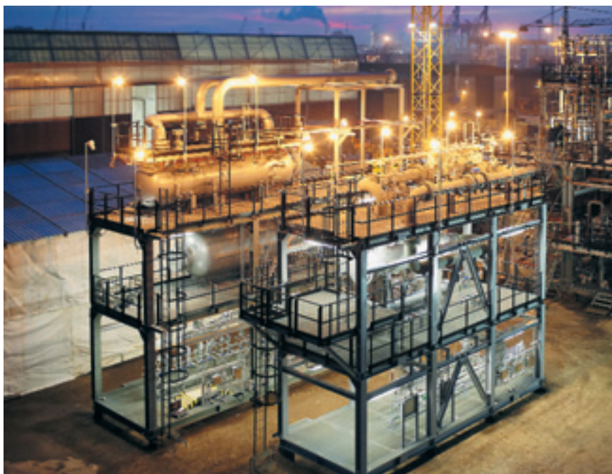
Фото 1. Система газоподготовки для ПГУ-110 Астраханской ГРЭС
