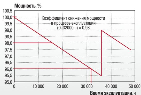
Рис. 5. Снижение мощности электростанции в зависимости от наработки
