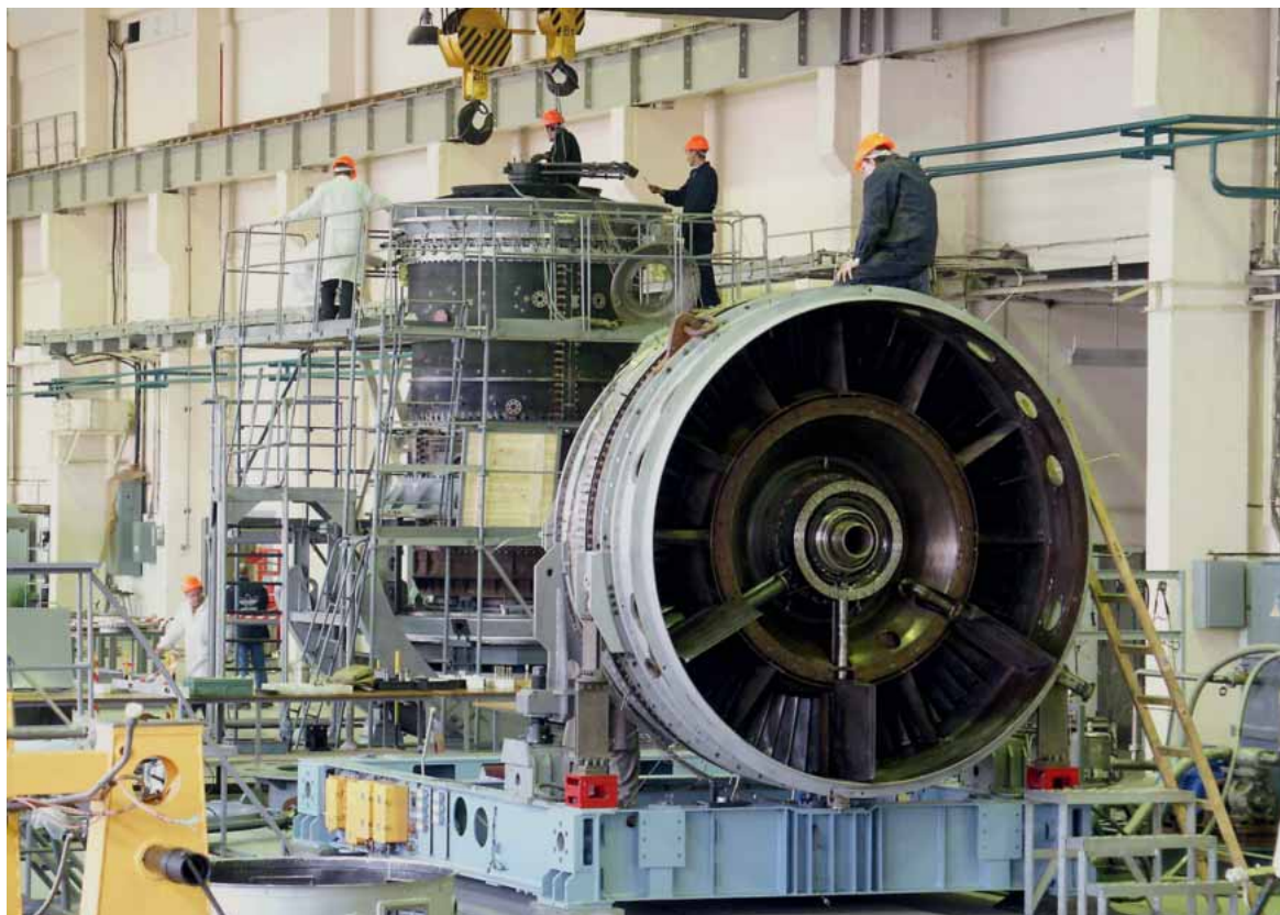
Газотурбинный двигатель ГТД-110 в сборочном цехе НПО «Сатурн»
