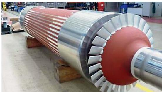
как газотурбинных, так и паросиловых установок. Проектные параметры генератора SGen5-100A-2P для Грозненской ТЭС: номинальная мощность 218 МВА, номинальный коэффициент мощности 0,85, КПД 98,7%, допустимая длительная мощность 248 МВА, напряжение 15,75 кВ.
