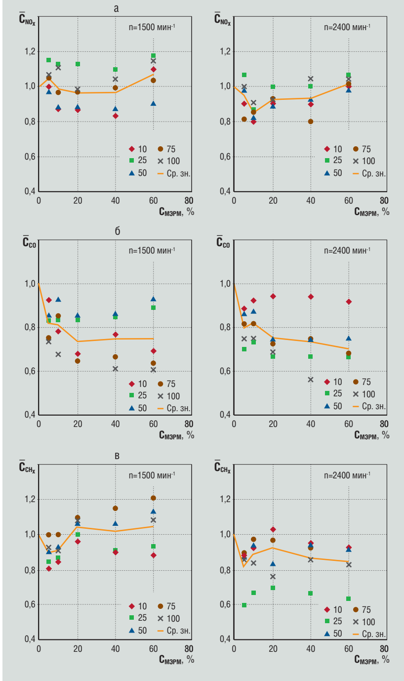
Рис. 5. Зависимость относительной концентрации в ОГ оксидов азота C_{NO_x} (а), монооксида углерода C_{CO} (б), несгоревших углеводородов C_{CH_x} (в) от содержания в смесевом биотопливе метилового эфира рапсового масла C_{MЭРМ} при работе дизеля на режимах 13-ступенчатого испытательного цикла с частотой вращения n=1500 \text{ мин}^{-1} и n=2400 \text{ мин}^{-1} и различной нагрузкой (10, 25, 50, 75 и 100 %); сплошной линией показаны средние значения токсичных компонентов
